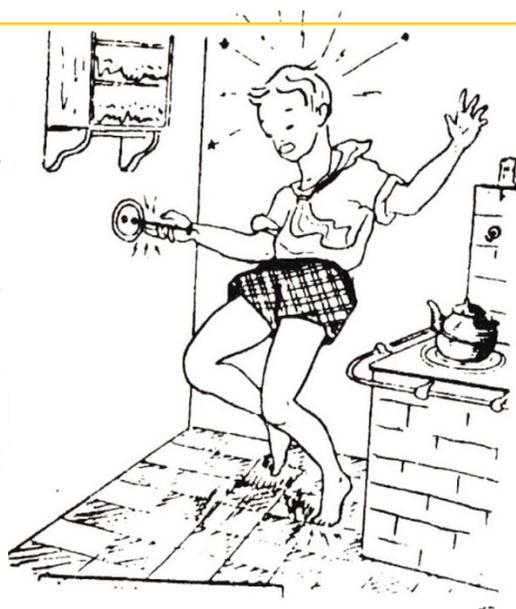
3. **Нельзя пользоваться выключателями, штепсельными розетками, вилками, кнопками звонков с разбитыми крышками, а также бытовыми приборами с поврежденными, обуглившимися и перекрученными шнурами.** Это очень опасно! Никогда не тяните вилку из розетки за провод и не пользуйтесь вилками, которые не подходят к розеткам.
